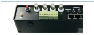
Abb.: Sehen Sie hier die 4 BNC-Kameraeingänge des securityProbe Monitoringsystems. Unter den BNC-Eingängen sehen Sie die Pelco D RS485 Anschlüsse für die Steuerung der Schwenk-Neige-Domekamera.
