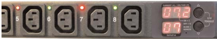
Rückseite der 1 U-PDU zeigt Stromaufnahme für Ausgang Nr. 7 an. Rote LEDs weisen auf eingeschaltete Ausgänge hin. Grüne LEDs weisen auf ausgeschaltete Ausgänge hin.
