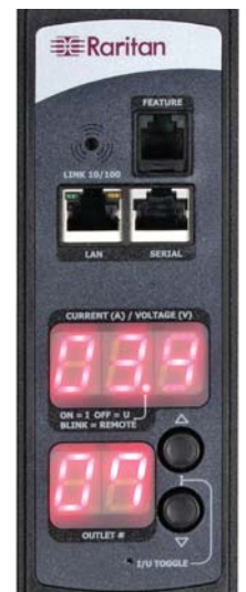
Oben: Verbindung für Umgebungssensoren. Mitte: TCP/IP und serielle Ports für Remote-zugriff. Unten: LED-Anzeige von Effektivspannung und -strom auf Einheits- und Ausgangsebene.
