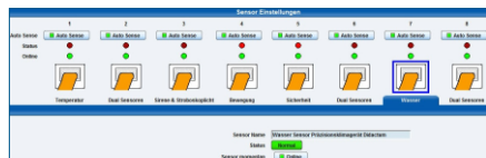
Abb. 1: Einstellungen der einzelnen Sensoren werden im leicht bedienbaren, deutschsprachigen Webinterface der securityProbe-5ES vorgenommen. Hier tragen Sie auch die Warn- und Schwellenwerte sowie die gewünschten Alarm- und Benachrichtigungsarten ein.
