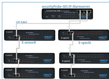
Abb. 2: Flexible Erweiterung der securityProbe5ES mit optional bei Didactum erhältlicher Erweiterungsmodul für weitere Sensoren oder potentialfreie Kontakte. Mit einer einzigen sensorProbESS und einer entsprechenden Zahl von Erweiterungsmodulen können bis zu 500 intelligente Sensoren überwacht werden. Ideal für das Monitoring großer Infrastrukturen wie Rechenzentren oder Telekommunikationsanlagen.
