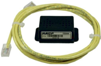
Abb.: Sehen Sie hier den DualSensor Temp. & Luftfeuchte (Art. 10174). Dieser Multi-Sensor wird nach ISO-Standard dauerhaft kalibriert und bietet so eine präzise Temperatur und Luftfeuchtemessung. Per CatX Netzwerkkabel kann dieser Sensor bis zu 300 Meter entfernt von der sensorProbe4 abgesetzt werden.
