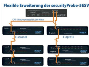
Abb.: Durch Montage von E-sensor8 oder E-opto16 Einheiten kann ein jedes aktuelle securityProbe-5ESV/-5ESV Monitoring System bis zu 500 Sensoren überwachen.
