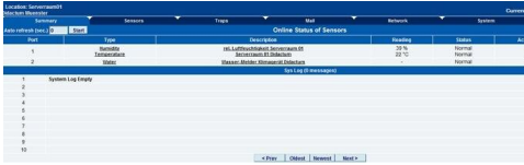
Abb.: Die angeschlossenen Sensoren können im Webinterface des sensorProbe2 Monitoring Systems bequem konfiguriert werden. Jeder Sensor besitzt ein SNMP OID, so dass die Abfrage auch per SNMP Befehl über Netzwerk oder Internet erfolgen kann.
