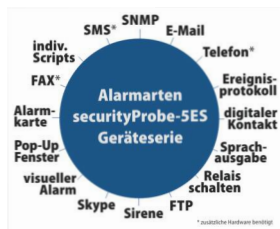
Abb.: Die securityProbe-5ES IP-AlarmServer bieten umfangreiche Arten der Alarmierung. Auch ein geordneter Shutdown der Server kann eingeleitet werden.
