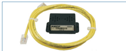
Abb. A: Ein SNMP-fähiger DualSensor Temperatur & Luftfeuchtigkeit (AK-TH500) ist bereits im Lieferumfang des securityProbe-X20 IP-AlarmServers enthalten. Optional können Sie diesen Sensor mit herkömmlichen CAT-5 Kabel bis zu 300 Meter entfernt von der securityProbe-X20 absetzen. Weitere Sensoren sehen Sie auf unserer Internetpräsenz http://www.AKCP-Sensor.de/ .
