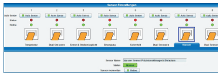
Abb.1: Einstellungen der einzelnen Sensoren werden im intuitiv bedienbaren Webinterface der neuen AKCP securityProbe-5E vorgenommen. Hier tragen Sie auch die Warn- und Schwellenwerte sowie die gewünschten Alarm- und Benachrichtigungsarten ein.
