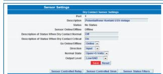
**Abb.:** Im Webinterface des sensorProbe Monitoringsystems kann der Sensor potentialfreier Kontakt bequem konfiguriert werden. Danach geben Sie die Alarmierungsarten bei Störungsmeldung Ihrer Anlage ein. Zeit- und Wochentagsfilter können auf Wunsch ebenfalls gesetzt werden.
