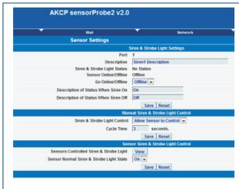
**Abb.:** Die AlarmSirene mit integriertem Stroboskopblitzlicht kann im Webinterface des sensorProbe2 Monitoringsystems bequem konfiguriert werden.
