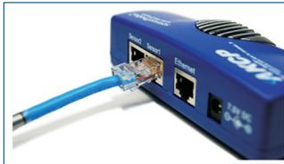
**Abb.:** Stecken Sie einfach das Cat5-Kabel des Sensors DC-Gleichstrom in einen freien Sensoranschluss des AKCP Netzwerküberwachungsgeräts (hier: sensorProbe2). Per AutoSense Technik wird der Sensor automatisch identifiziert. An dem zweiten Sensoranschluss können Sie einen weiteren IP-fähigen DC-Voltage Sensor anbringen. Das Datenblatt intelligente Sensoren gibt Ihnen weitere Auskünfte.
