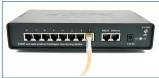
**Abb.:** Das Cat5-Anschlusskabel des sensorgesteuerten Gleichstromrelais wird einfach in einen Sensoranschluss des AKCP Monitoringsystems gesteckt (Bild: sensorProbe8). Das DC-Relais wird automatisch identifiziert! An die weiteren freien Sensoranschlüsse schliessen Sie dann diejenigen intelligenten Umwelt-Sensoren an, welche mit dem Gleichstromrelais in Aktion treten sollen. Zum Beispiel Sensor Temperatur bei Überhitzung im Raum oder Sensor Wasser bei Leckage.
